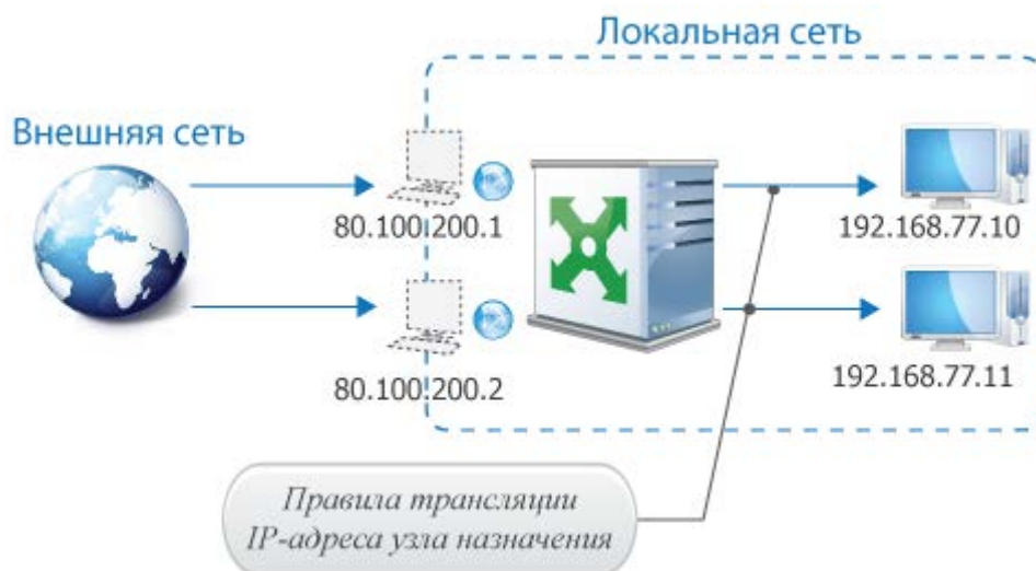
Рисунок 18. Доступ к внутренним ресурсам при помощи правил трансляции IP-адресов узлов назначения
