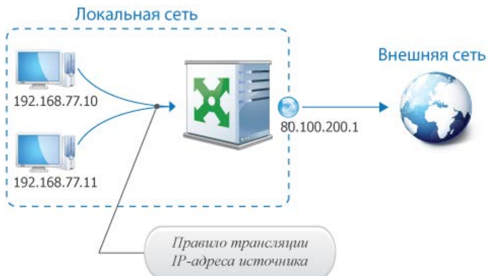
Рисунок 19. Организация доступа в Интернет при помощи правила трансляции IP-адреса источника
