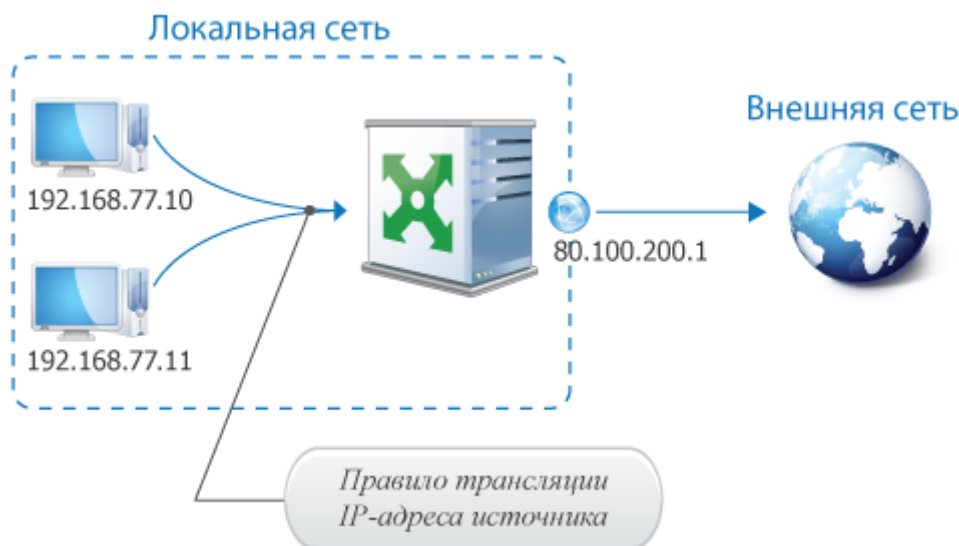
Рисунок 12. Организация доступа в Интернет при помощи правила трансляции IP-адреса источника
