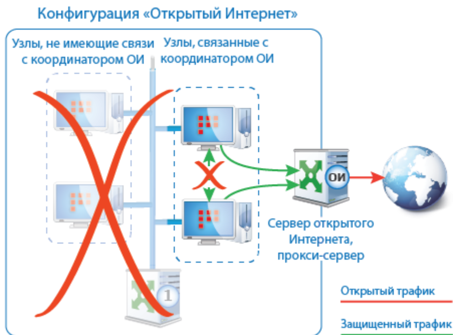
Рисунок 3. Схема работы в режиме «Открытый Интернет»
