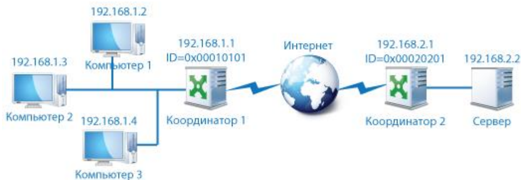
Рисунок 22. Схема настройки туннелей с использованием координаторов ViPNet
