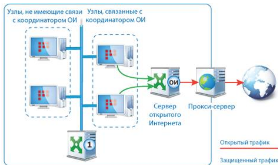
Рисунок 2. Технология «Открытый Интернет» с выделенным прокси-сервером
