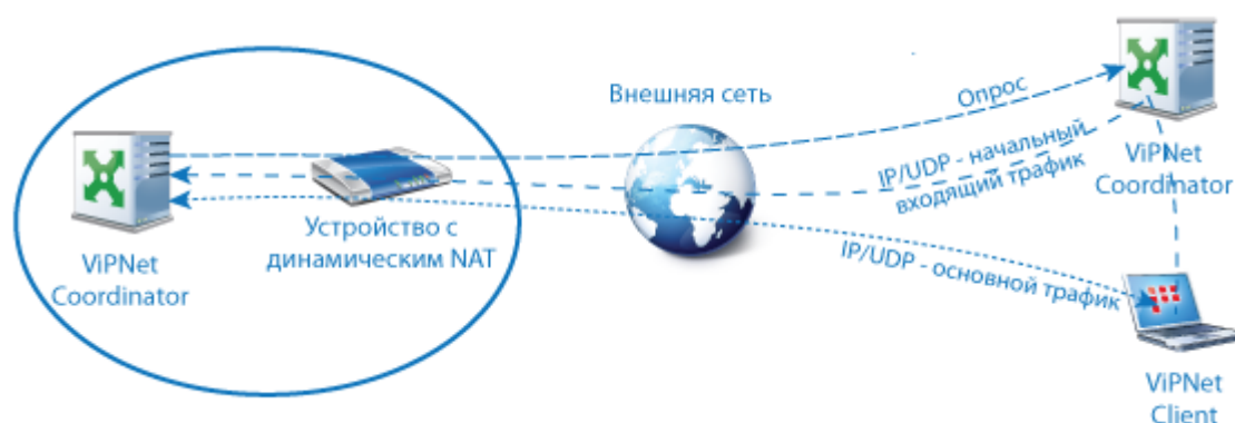
Рисунок 1. Организация трафика узла, работающего через устройство с динамическим NAT
